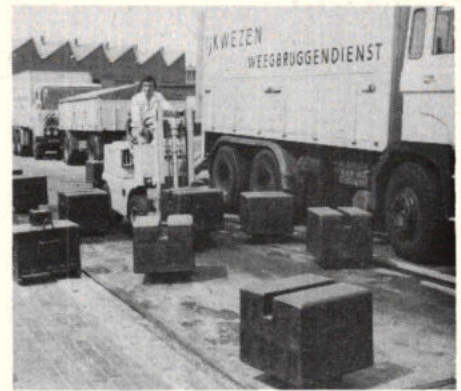
Afb. 18. Onderzoek van een weegbrug door de Dienst van het IJkwezen.
